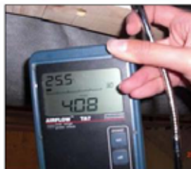
Rif. 6 Locale: Matrimoniale SOPPALCO Perdita: sigillatura telo-soffitto 4,08
