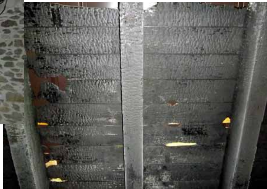
Copertura in legno isolata con pannelli di fibre di cocco – Camino a diretto contatto in acciaio a doppia parete con isolamento 20 mm
